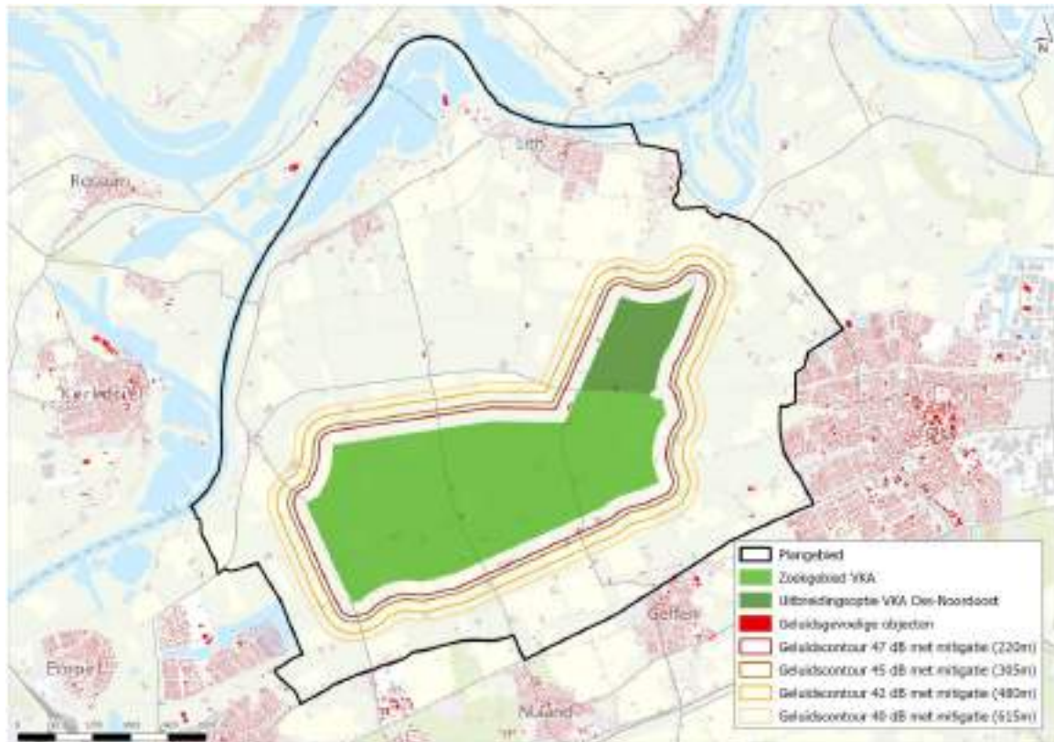
Afbeelding 14.29 Ligging geluidcontouren met mitigatie rondom het zoekgebied VKA inclusief uitbreidingsoptie Oss voor turbinetype 1
